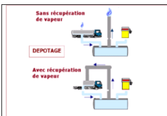
Figure 1: Schéma explicatif de la récupération de vapeur "stage I".
