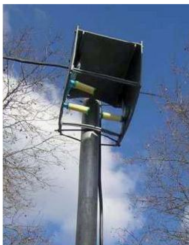
Figure 4 : Dispositif de mesure par tubes à diffusion passive.
