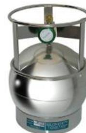
Figure 8: Illustration d'un préleveur canister
