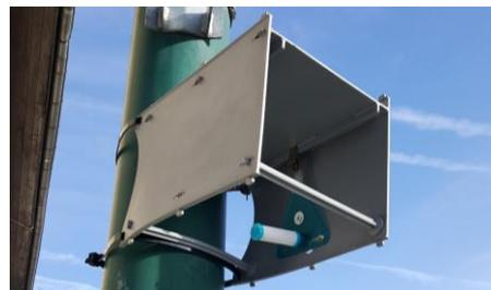
Figure 7: Illustration d'un tube à diffusion passive
