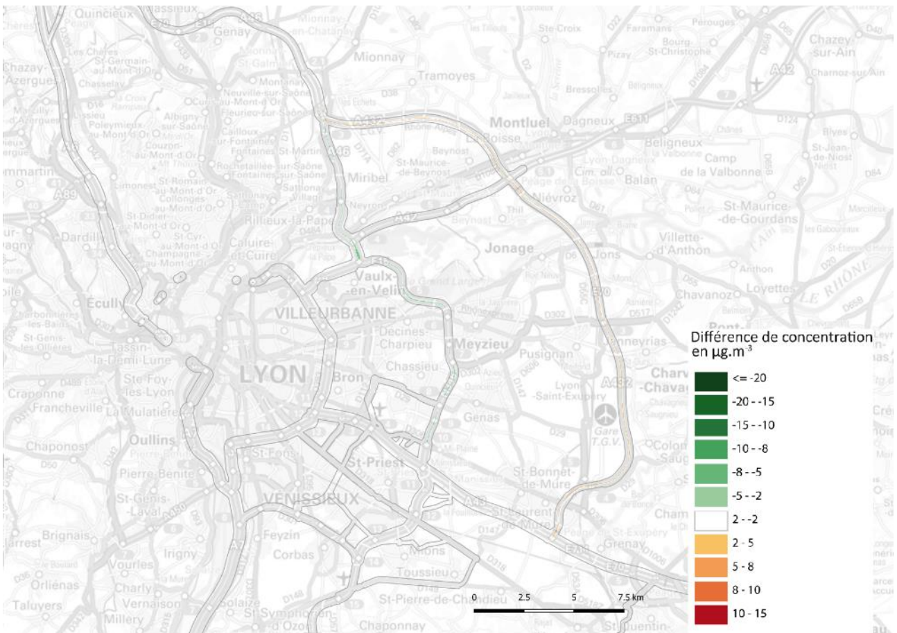
Impact du report du trafic de transit sur le scénario 2030 avec aménagement de l'A46 Sud à 2x3 voies – zoom sur l'A432
