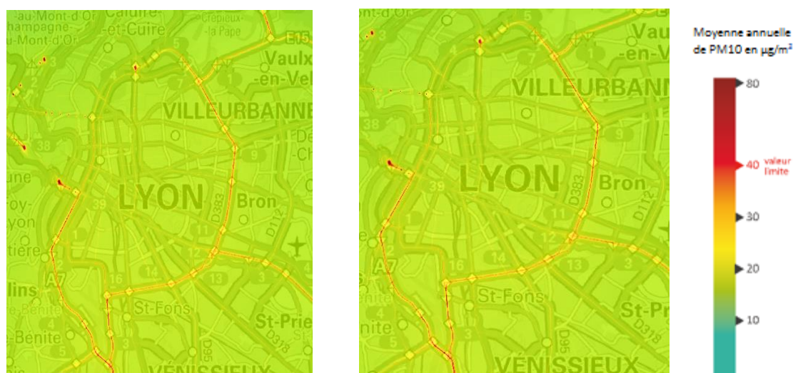
Figure 12 : Cartes de concentrations en PM10 pour chaque scénario A gauche le scénario « 70km/h » / A droite le scénario « 90km/h »
