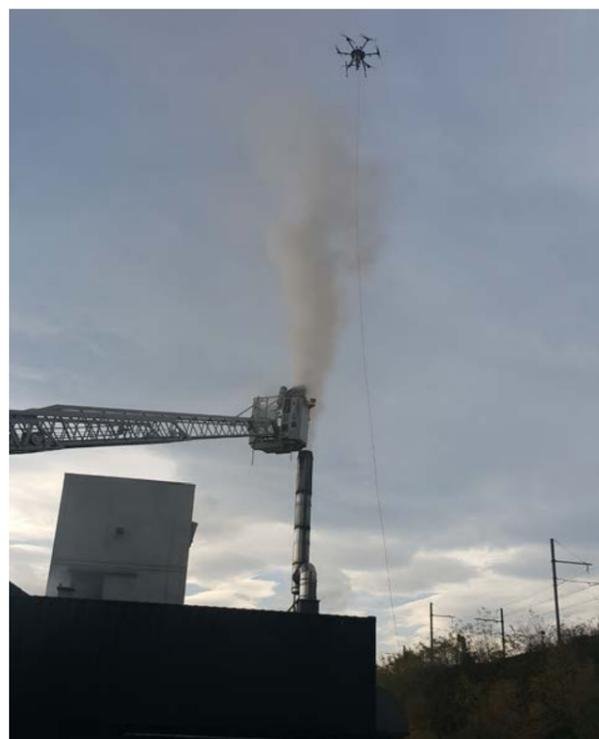
Test du drone dans un panache de fumée d'un incendie simulé avec les pompiers du SDIS73 à Montmélan en novembre 2021.
