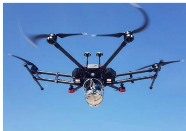
Test du dispositif de prélèvement d'air par canister (récipient métallique) sous le drone.
