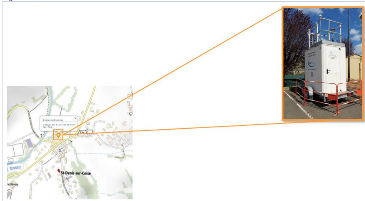
Figure 22 : Installation d'un dispositif de mesures des polluants ( \text{CH}_4 , \text{NH}_3 , \text{H}_2\text{S} , \text{PM}_{10} ) et paramètres météorologiques dans le centre du village de la commune de Saint-Denis-sur-Coise (42)
