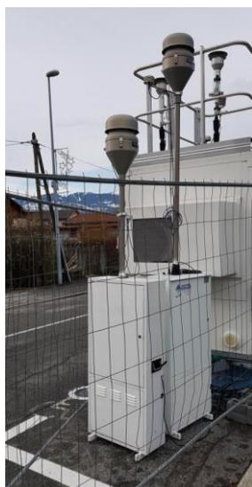
Les prélèvements de HAP ont été effectués par des préleveurs haut-débit (Digital DA80) permettant de capturer les phases particulaire et gazeuse, conformément aux prescriptions nationales (cf. Figure 3). Les mesures délivrées, après analyse en laboratoire, sont des concentrations journalières.
