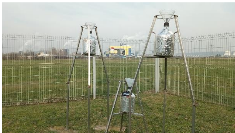
Figure 46 Jauges installées dans l'enceinte de la maison de projet
