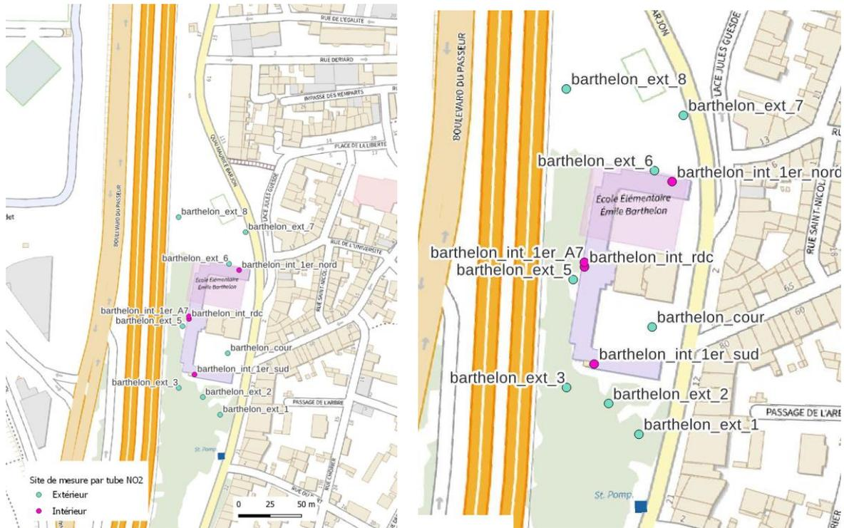
Figure 8 : Localisation des sites de mesure par tubes passifs NO<sub>2</sub> autour et à l'intérieur de l'école Barthelon à Bourg-les-Valence
