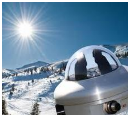
Figure 2 : Photo illustrant un pyranomètre solaire installé en milieu montagneux. Source :
