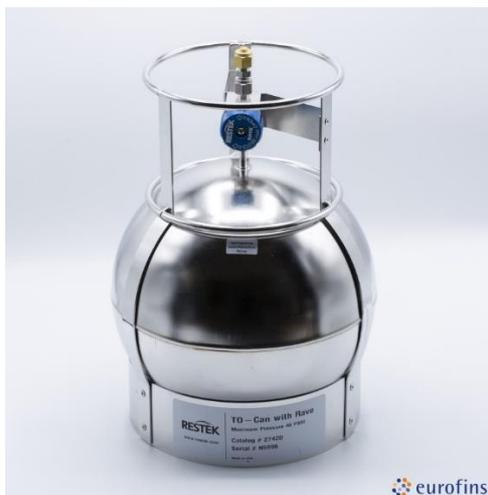
Figure 6 : Exemple de canister de 6L (Source : Eurofins)
