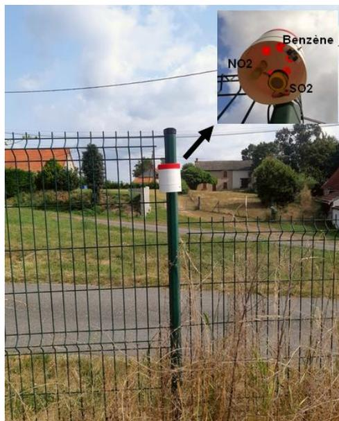
Figure 7 : Dispositif de prélèvement par capteur passif (Point L4)
