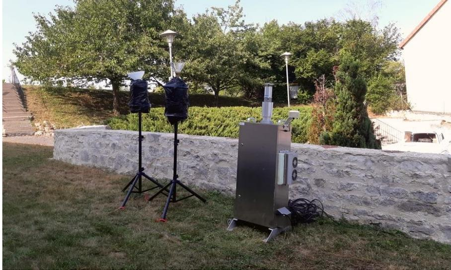
Figure 8 : Dispositif de prélèvement par capteur passif (Point F1)
