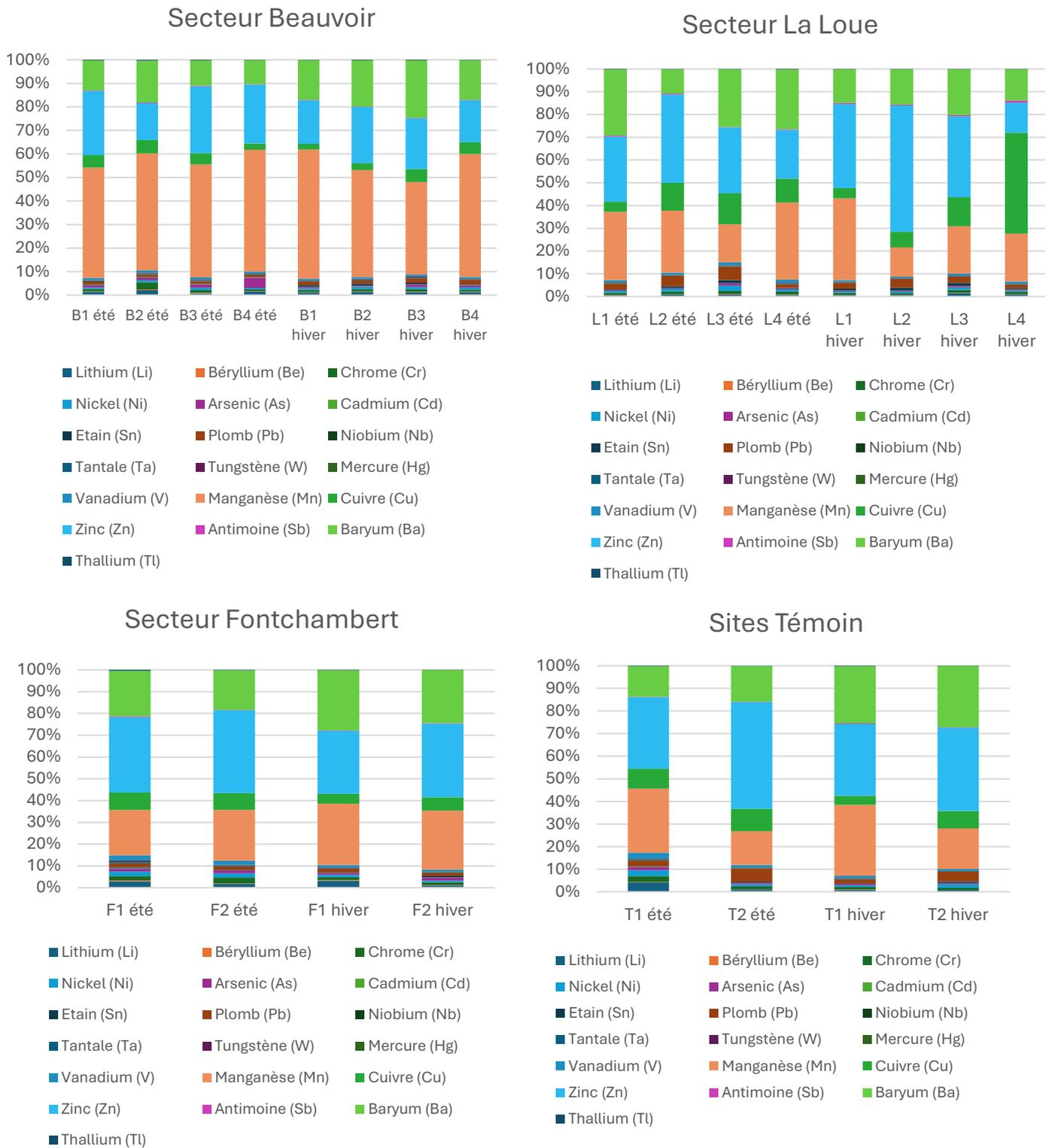
Figure 30 : Profils des dépôts atmosphériques selon les secteurs
