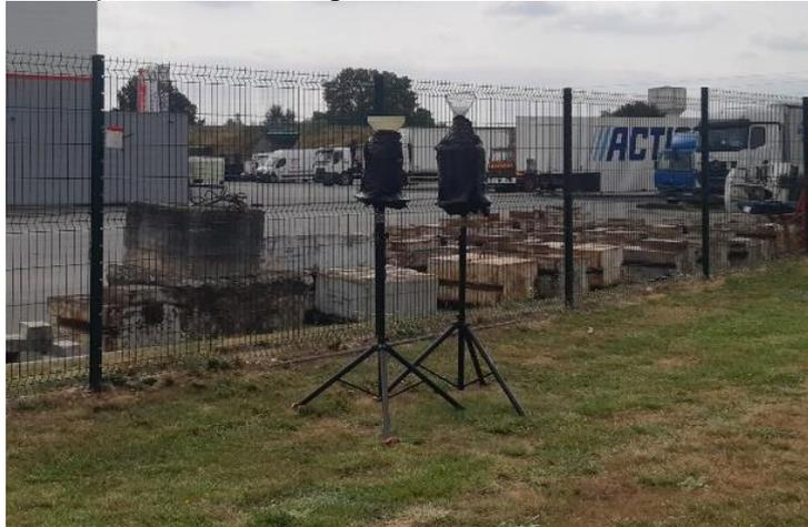
Figure 11 : Dispositif de prélèvement par jauge Owen (Point L2)
