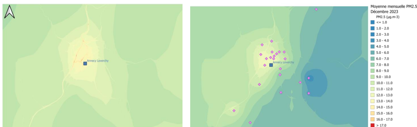
Figure 42 : Cartographie (moyenne mensuelle) de la concentration en particules PM2.5 ( \mu\text{g.m}^{-3} ) avec la méthode Combine classique (gauche), la méthode Krigeage fine échelle intégrant les données de micro-capteurs fixes (droite) pour le mois de décembre 2023.
