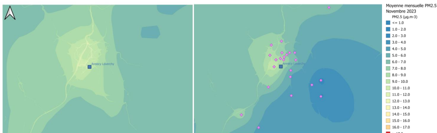
Figure 41 : Cartographie (moyenne mensuelle) de la concentration en particules PM2.5 ( \mu\text{g.m}^{-3} ) avec la méthode Combine classique (gauche), la méthode Krigeage fine échelle intégrant les données de micro-capteurs fixes (droite) pour le mois de novembre 2023.
