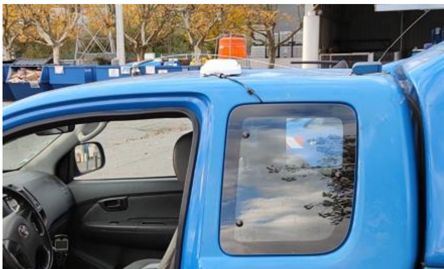
Figure 5 : Capteur AtmoTrack positionné sur un véhicule ENEDIS
