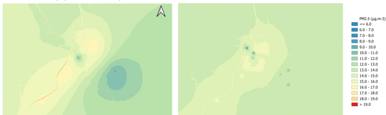
Figure 48 : Test d'intégration des micro-capteurs en mobilité dans les cartographies du territoire - 23 novembre 2023. A gauche, cartographie intégrant uniquement les micro-capteurs fixes, à droite, cartographie intégrant les micro-capteurs fixes et mobiles.
