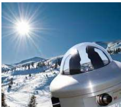
Figure 2 : Photo illustrant un pyranomètre solaire installé en milieu montagneux. Source : https://www.essearch.com/delta-t-spn1-pyranometer-in-australia/
