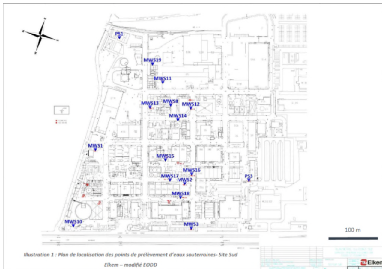
Figure 3 : Plan d'implantation des piézomètres (source : EODD)
