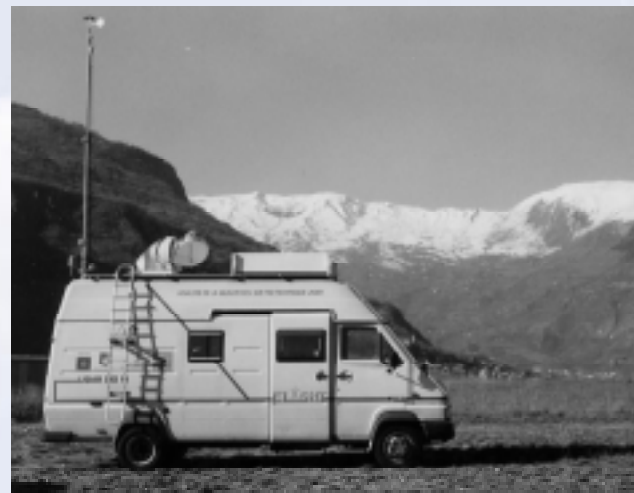
Figure 1 : le camion LIDAR de COPARLY
